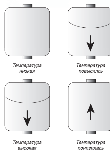
Рис. 1 Схема работы расширительного бака при изменении температуры рабочей жидкости
