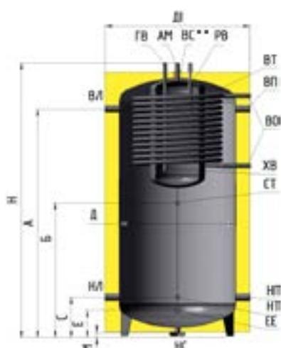
Рис 2 Линейка баков ББ-VT с верхним теплообменником
