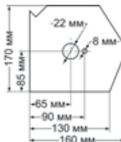
Рис.7. Геометрические размеры теплообменника СВК-А
