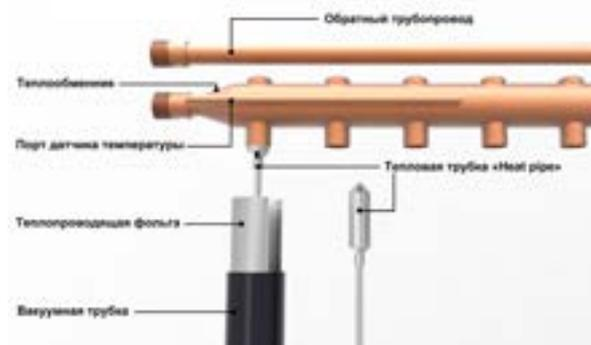
Рис 3. Конструкция теплообменника солнечного вакуумного коллектора
