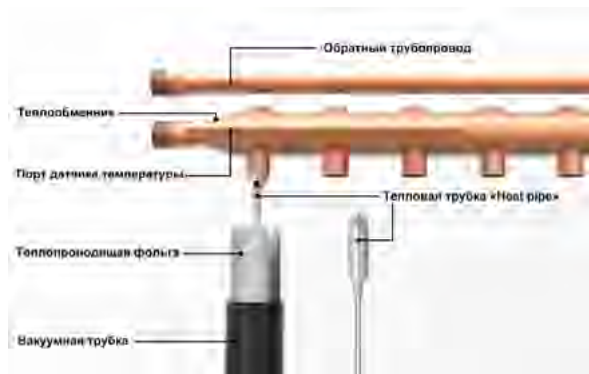
Рис.3. Конструкция теплообменника солнечного вакуумного коллектора
